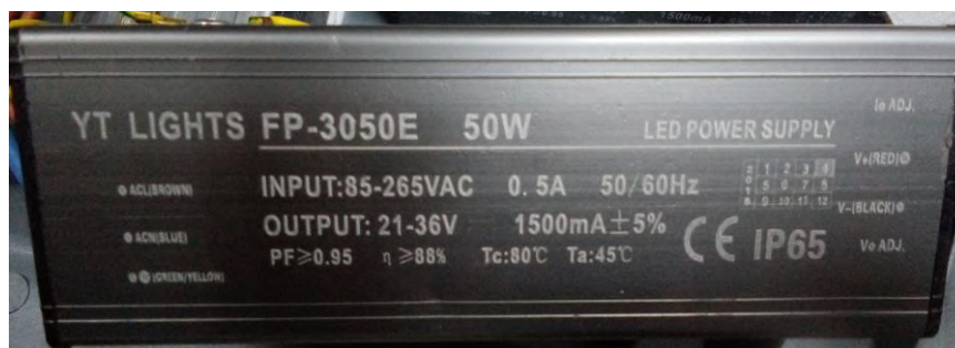
Figura 04 – Drive da Luminaria
